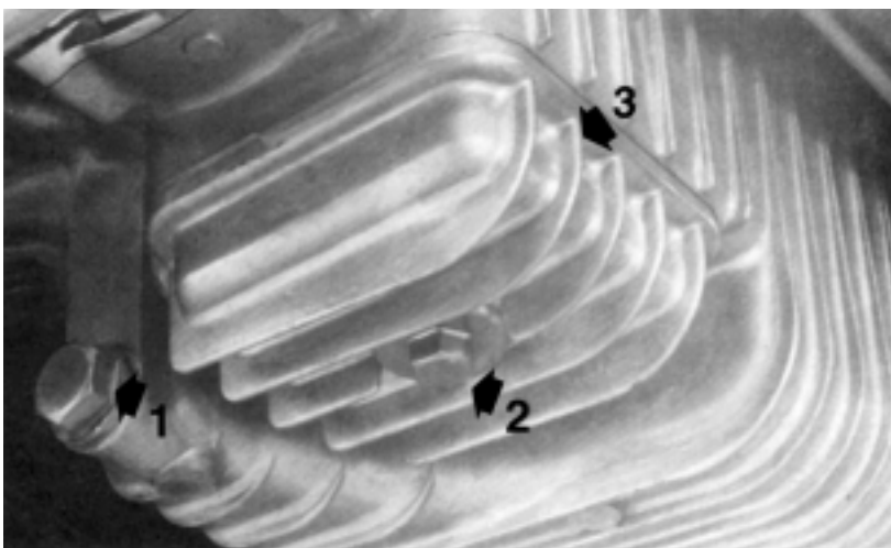
(1) PARAFUSO DE DRENAGEM (2) PARAFUSO DO FILTRO DE ÓLEO
